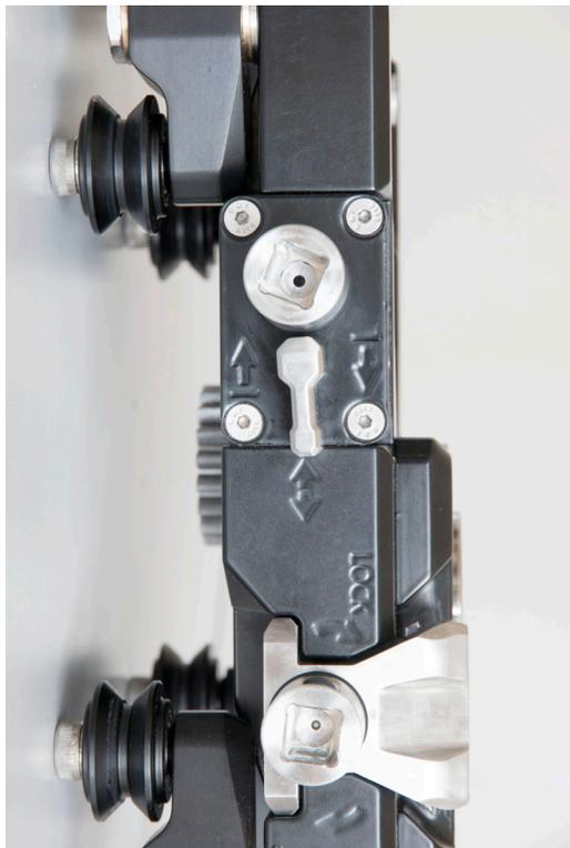
Regolare la levetta sul CENTRO. Montare il carrello sulla colonna e farlo scendere. Girare la levetta verso l'ALTO in modo che il carrello non possa più scendere.
