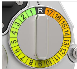
Per invertire il senso di rotazione del motore, premere il tasto **START/STOP** tenendo il tasto "R" premuto ed attendere che il motore cominci a girare in senso inverso.
