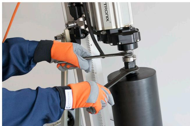
Se necessario, aiutarsi anche con l'inversore di marcia. Se il potenziometro 2 per la variazione di velocità (giri/min) è su "R", l'albero si arresta automaticamente.
